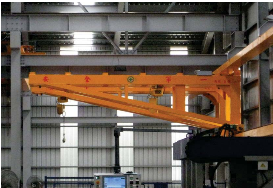
圖 1-3-1 牆裝型懸臂式起重機
