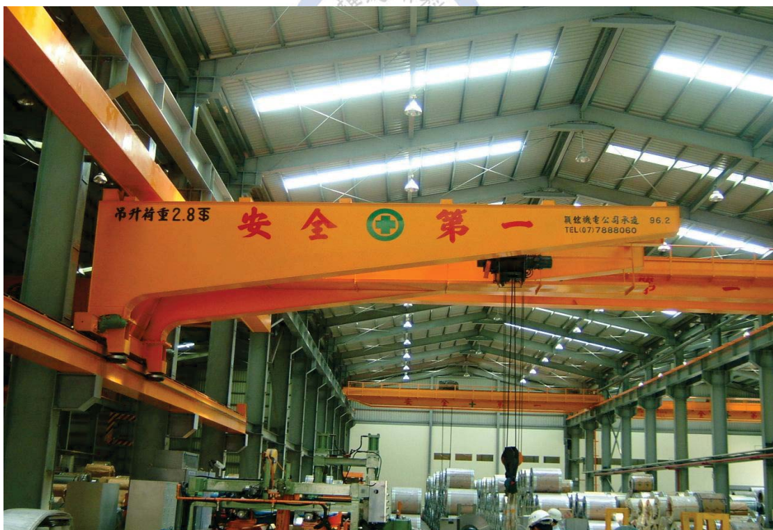
圖 1-3-2 牆裝型懸臂式起重機
