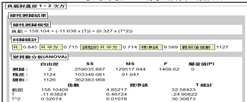
圖 23 台北供電區營運處台北 P/S 變電所負載對溫度迴歸模型圖
