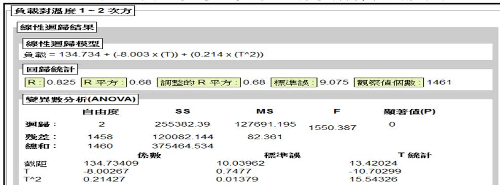
圖 16 高屏供電區營運處四維 D/S 變電所負載對溫度迴歸模型圖
