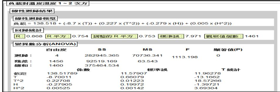
圖 18 高屏供電區營運處四維 D/S 變電所負載對溫溼度迴歸模型
