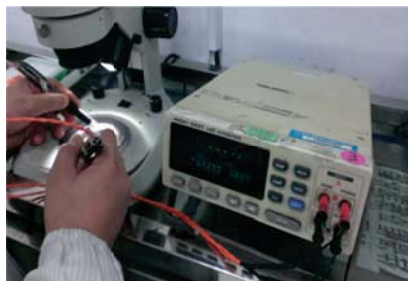
圖 4-7 鐳射修整之人工手動量測(改善前)
