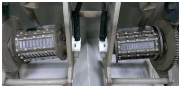
圖 4-10 端子製作改善後小批量生產(小滾筒)
