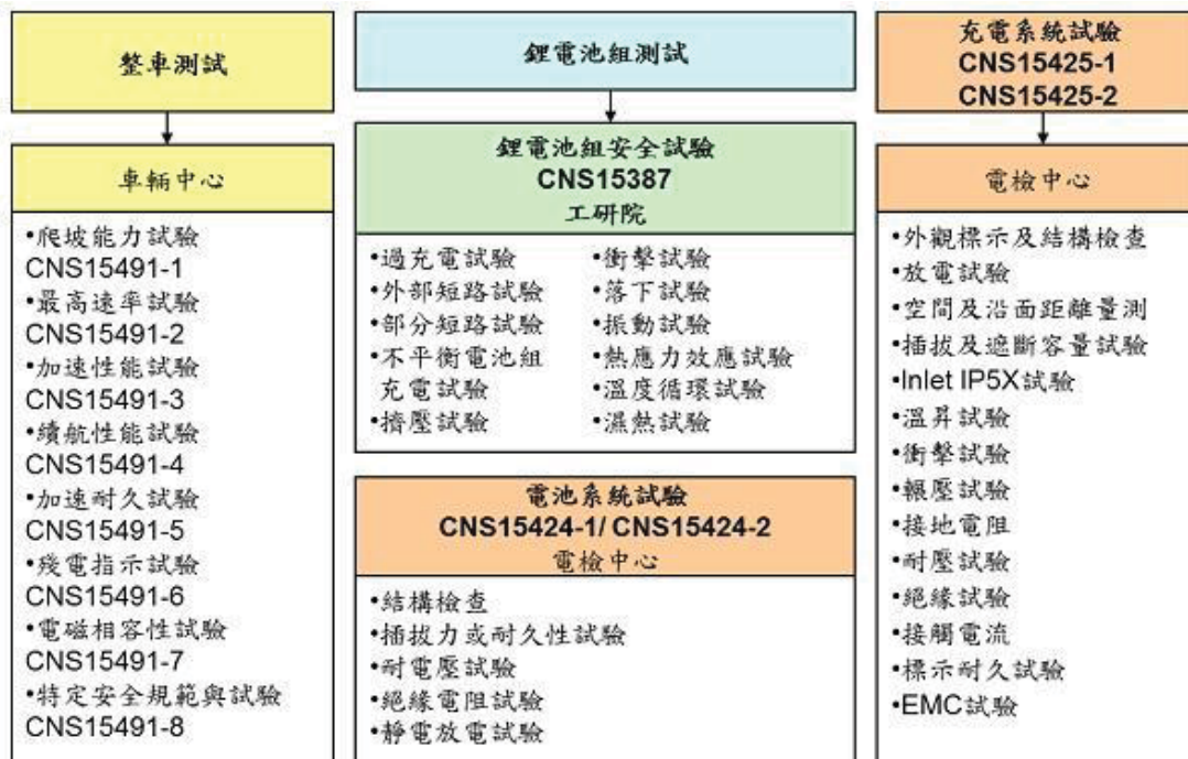
圖 3 電動機車性能及安全測試項目
