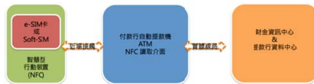
圖 10 晶片金融卡與手機晶片結合流程 (本文整理)
