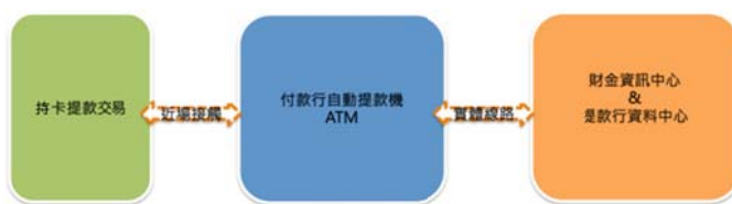
圖 3 現行 ATM 自動化交易流程如圖 (本文整理)
