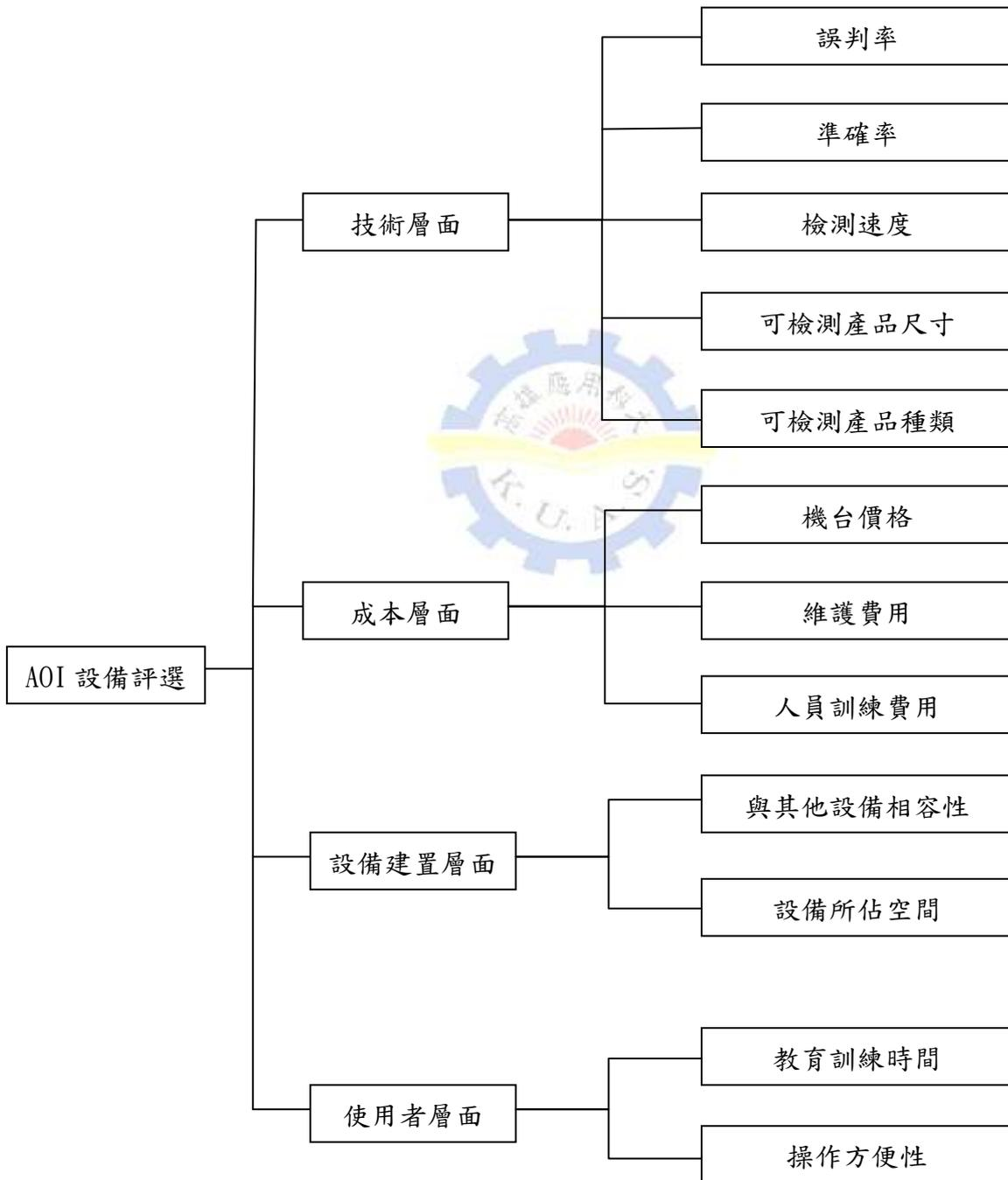
圖1 AOI設備選擇層級架構圖
